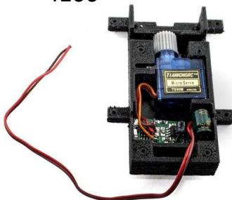
**PLUG (Servosignalantrieb mit Funktionsausgang)**
